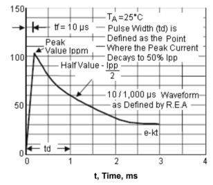
Fig. 3-Pulse Waveform
